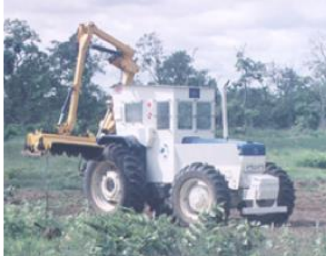
صورة 3: جرار مصّفح مزوّد بقواطع لإزالة الغطاء النباتي (المرجع: المعايير الدولية للإجراءات المتعلقة بالألغام (TN 09.50/01))
