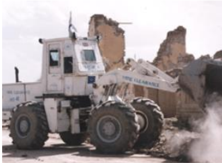
صورة 2: آلية تحميل مصفحة من الأمام والخلف تعمل على إزالة الأنقاض (المرجع: المعايير الدولية للإجراءات المتعلقة بالألغام TN 09.50/01)
